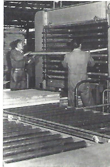
De deuren worden in de „tien-etagepers” ongeveer tien minuten onder hoge temperatuur geperst.
