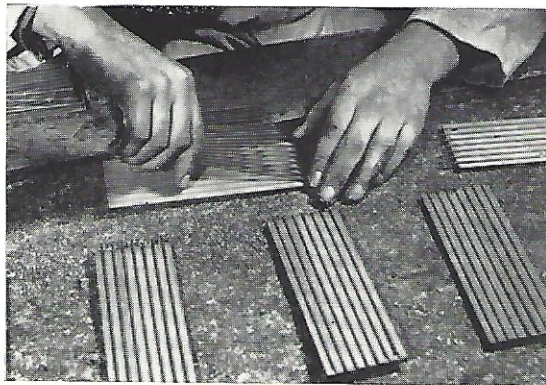
Potloodstiften worden in de groeven gelegd, waarna twee plankjes op elkaar worden gelijmd.
